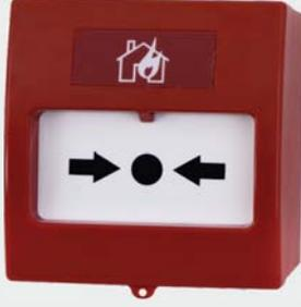
EN 54-11 sertifikalı, her marka konvansiyonel yangın algılama ve hırsız alarm sistemlerine bağlanabilmesi için tasarlanmıştır. Dahili 470 ohm direnç sayesinde montaj kolaylığı sağlar. Sıva altı ve sıva üstü montaja uygun yapıdadır. Opsiyonel olarak şeffaf koruma kapağı takılabilir. Özel anahtarı ile kolaylıkla yeniden kurulabilir. Şık tasarımı ile her ortama uyum sağlar.
