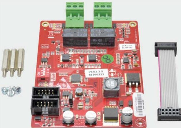
AF-1002L loop kartı, besleme hattı üzerinden üç birimlerle haberleşmeyi sağlamaktadır. 240 adet üç birim kontrol kapasitesine sahiptir.
